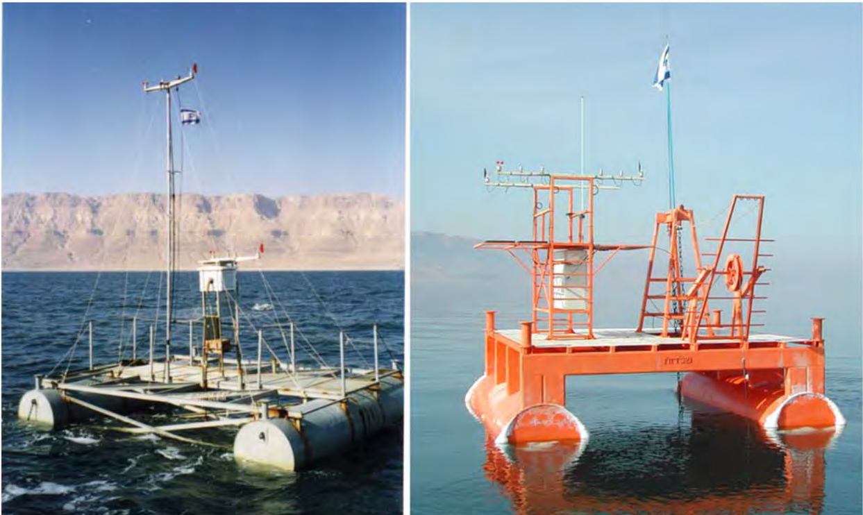
איור 6.1.1. שני דורות של מצופים מטאורולוגיים מעוגנים ב-100-EG (שמאל: דור ראשון בעבודה מיוני 1992 עד לפברואר 2002. ימין: דור שני בעבודה מאוקטובר 2004).
